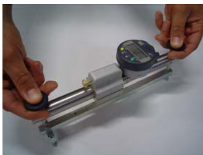
( indagine diagnostica con deformometro )
