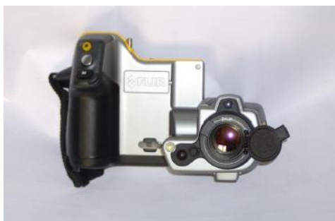
( indagine diagnostica con termocamera )
