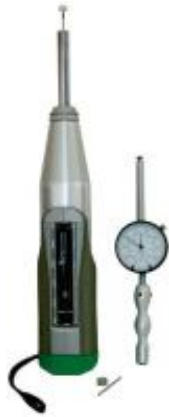
( verifica con sclerometro per legno e penetrometro )
